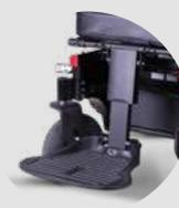
Placa del reposapiés con montaje central (Sling)
