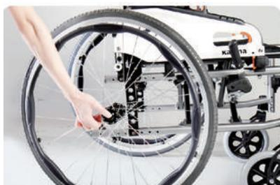
Eje de extracción rápida
